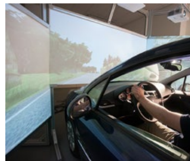
MSH Toulouse - plateforme CCU (Cognition, Comportements et Usages) - simulateur de conduite automobile SIMULAUTO pour l'étude sur l'attention du conducteur au volant © Frédéric MALIGNE/MSH Toulouse/CNRS Photothèque
